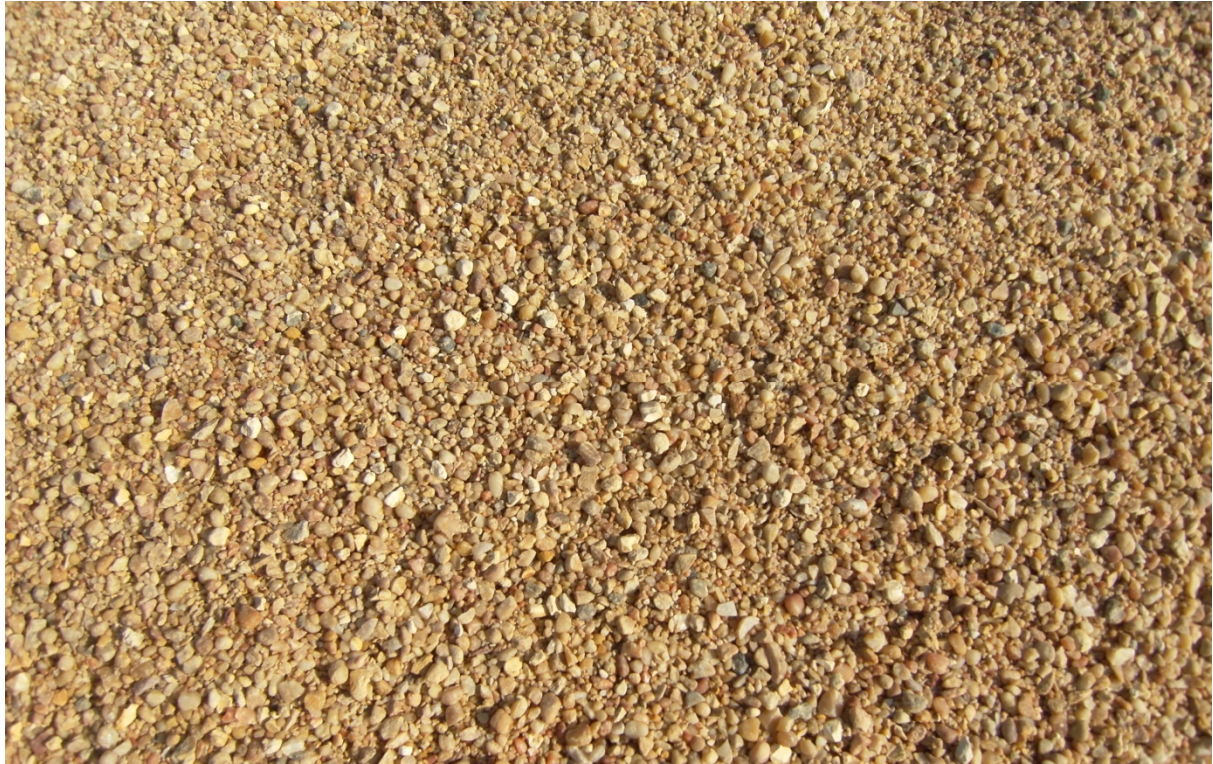
Nawierzchnia ze żwiru zaokrąglonego, płukanego o frakcji od 2-8mm w kolorze żółtym.
