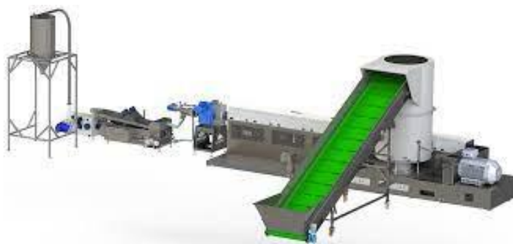
Rysunek 37 Linia technologiczna do przetwarzania odpadów z tworzyw sztucznych – przykład reprezentatywny 45
