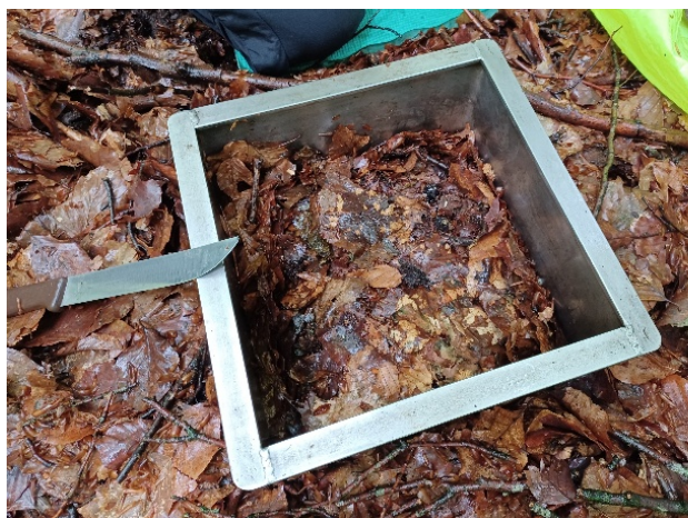
Rys. 18. Ramka do poboru poziomów organicznych
